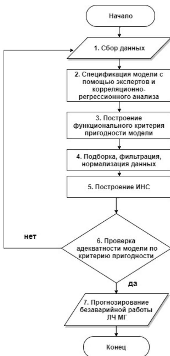
Рис. 1. Алгоритм функционирования системы мониторинга пожаро-взрывоопасности ЛЧ МГ
