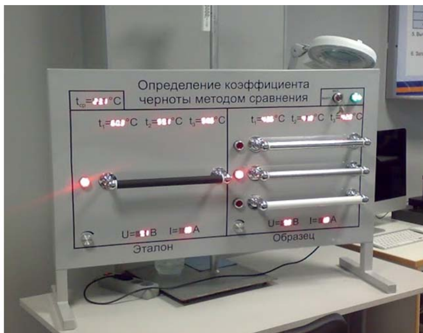
Рис. 1. Конструктивная компоновка установки для измерения степени черноты поверхности методом сравнения радиационных потоков
